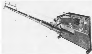
Рис. 58. Схема коронографа "Короноскоп-2". 1-3 - Внешние затеняющие диски, 4 и 7 - объективы, 5 - внутренний затеняющий диск, 6 - линза поля, 8 - плоские зеркала, 9 - затвор, 10 - кинокамера, 11 - светопоглотитель, 12 - затеняющий диск фотогида и датчики гидирования, 13 - входное отверстие для калибровки, 14 - объектив фотогида, 15 - рассеивающие поверхности, 16 - оптический клин и объектив.
